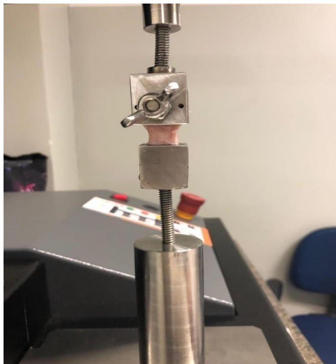
Figura 7. Ilustração da execução do teste de resistência mecânica das feridas cutâneas realizadas na máquina universal de ensaio.
