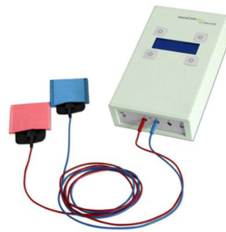
Figura 2: Esquematização do aparelho de ETCC com os eletrodos e as esponjas ânodo (Vermelho) e cátodo (Azul). Fonte: ( http://img.medicaexpo.com/images_me/photo-g/84837-5271271.jpg ).
