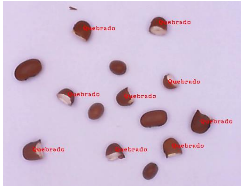
Figura 24 – Exemplo de resultado da detecção de grãos quebrados
