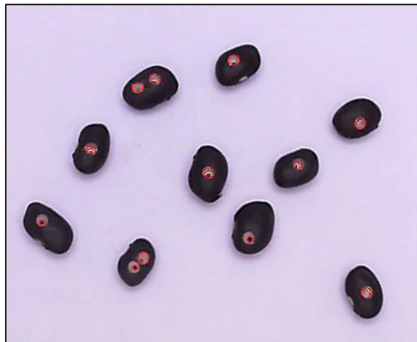
Figura 23 – Resposta do algoritmo de detecção de feijão carunchado
