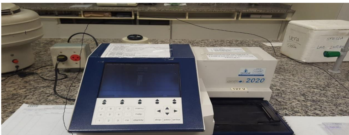
Figura 5. Leitor de ELISA com absorvância de 620 nm. (Anthos2020, Anthos Labtec instruments, Wals, Austria).
