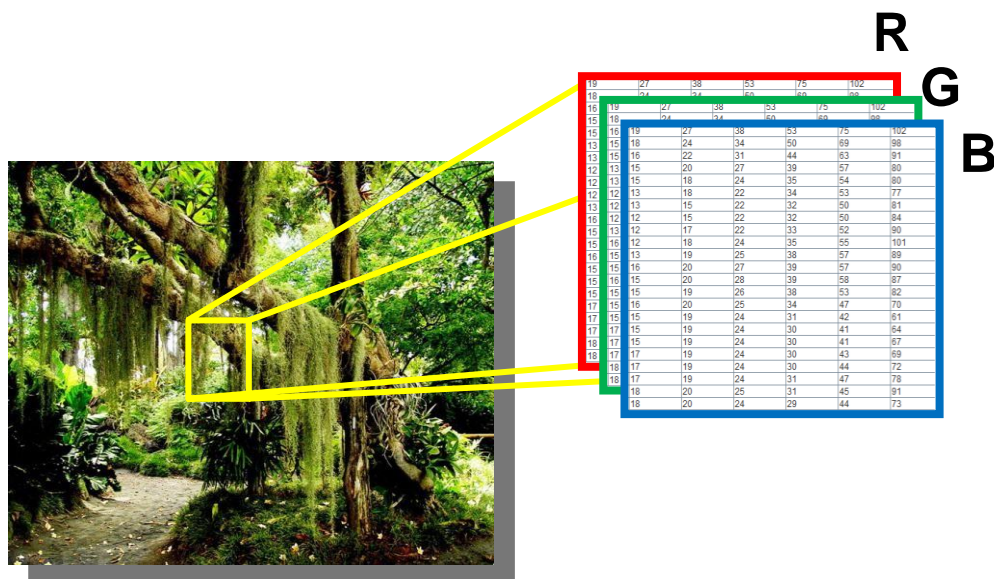
Figura 8: extração de dados de valores de intensidade da imagem digital em tabelas (padrão RGB).
