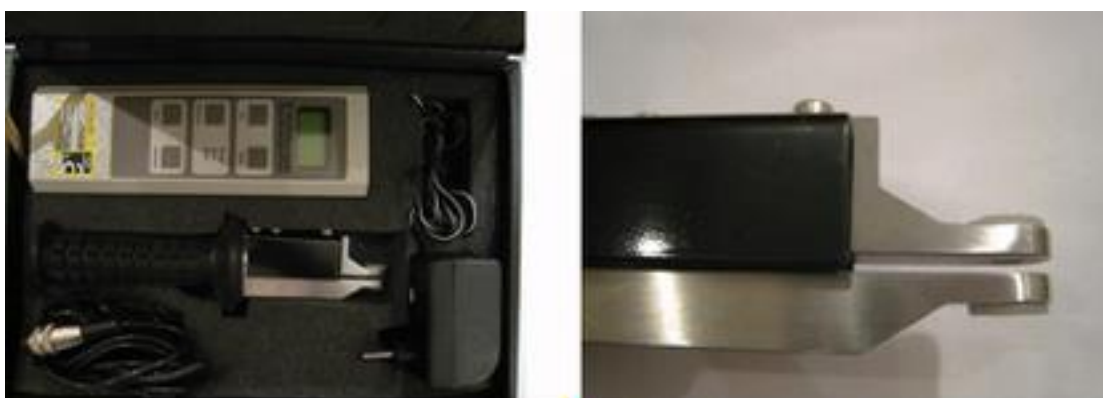
Figura 3: dinamômetro digital modelo DMD adaptado para as condições bucais.
