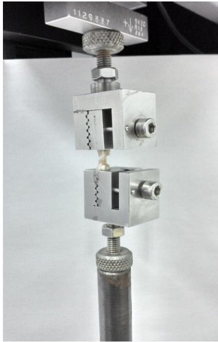
Figura 6: Aparelho Intermetric realização de ensaio de tração
