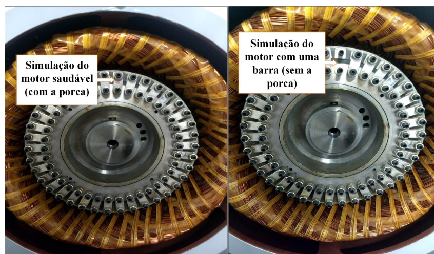
Figura 4.3: Simulação das barras rompidas no rotor para o MIT obtido com o fomento da FAPESP
