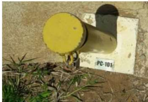
Figura 15. Piezômetro Casagrande instalado na barragem de terra da PCHo. Fonte: Guimarães e Oliveira, 2019
