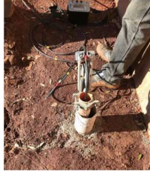
Figura 12. Inclinômetro instalado em campo Fonte: Mello, 2020
