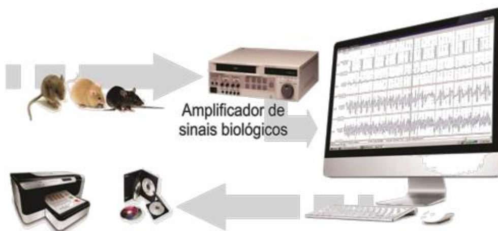
Figura 9. Esquema do sistema de registro de Pressão Arterial
