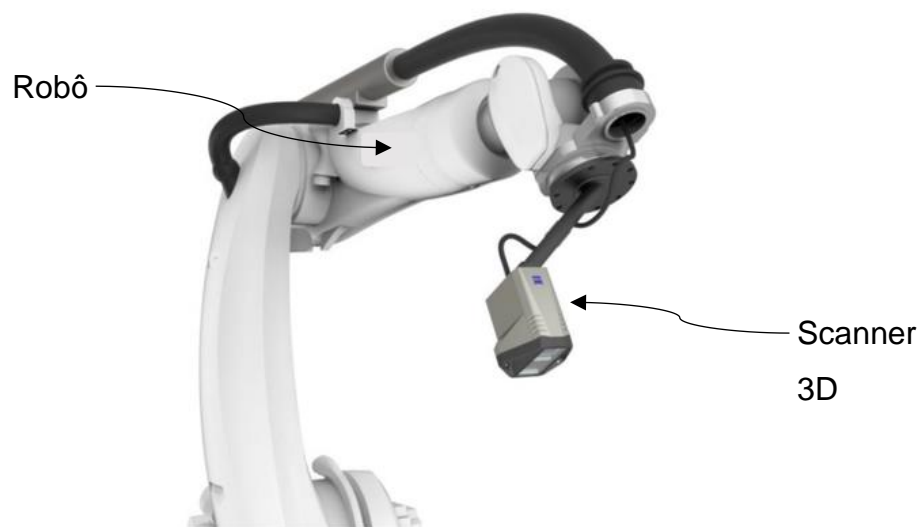
Figura 4 - Imagem ilustrativa do sistema de robô com scanner 3D acoplado
