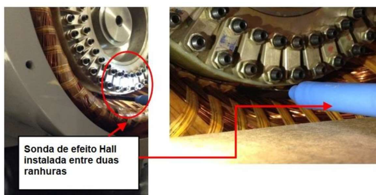
Figura 33 – Local onde a sonda Hall está posicionada no estator
