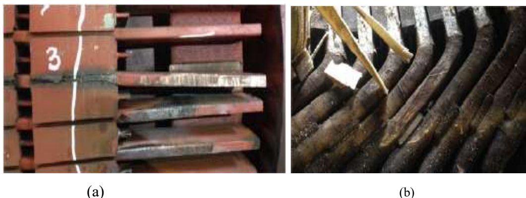
Figura 8 – Rotor de um motor 3.3 kV 450 kW
