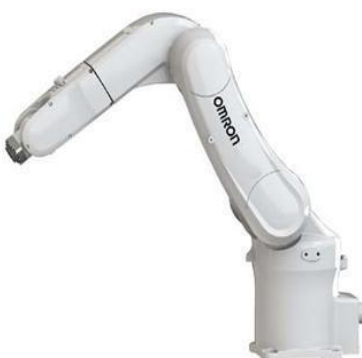
Figura 2 – Robô industrial com seis articulações.
