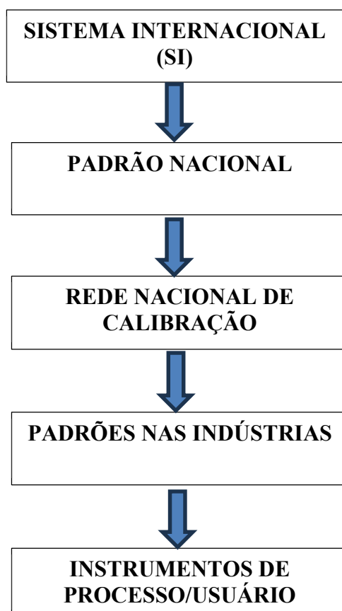
Figura 02 – Cadeia de rastreabilidade metrológica
