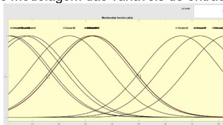
Figura 45– Exemplo de modelagem das variáveis de entrada usando o método SC
