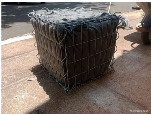
Figura 37. Corpo de prova preenchido pronto para o ensaio. Fonte: Dados da Pesquisa
