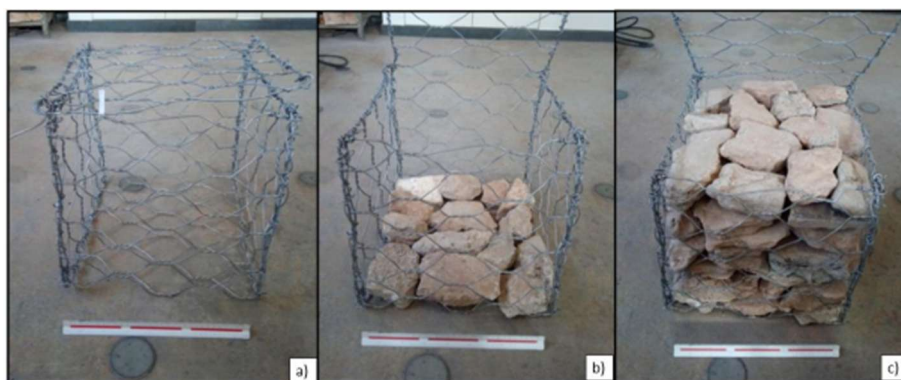
Figura 30. (a) Gabião vazio, (b) Início de montagem, (c) Gabião com RCD. Fonte: Ramos, 2022.
