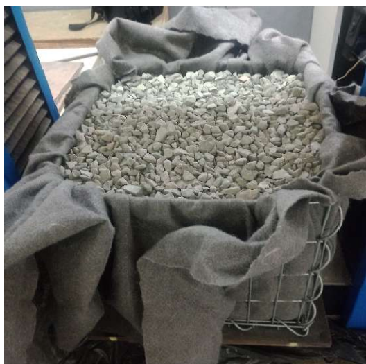
Figura 36. Corpo de prova preenchido com brita #2. Fonte: Dados da Pesquisa
