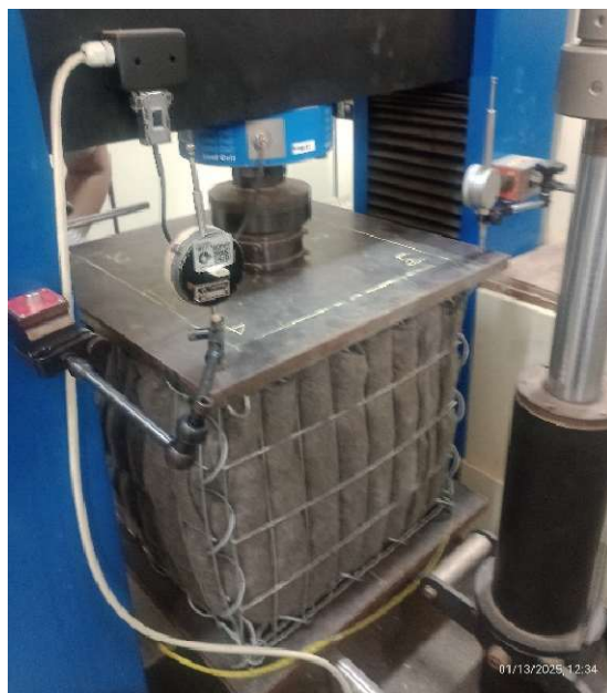
Figura 35. Ensaio de compressão em execução. Fonte: Dados da Pesquisa
