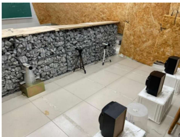
Figura 29. Disposição do emissor, com posicionamento decibelímetros. Fonte: Souza Junior, 2023.
