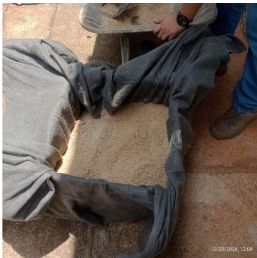
Figura 34. Preenchimento do corpo de prova com areia. Fonte: Dados da Pesquisa
