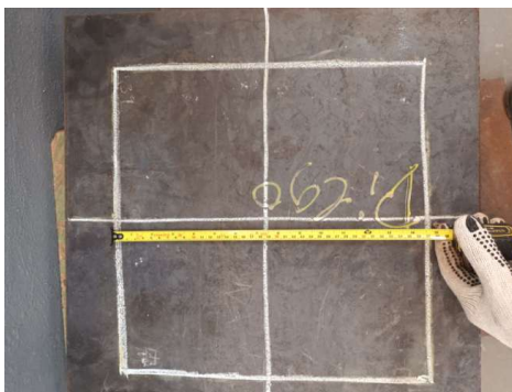
Figura 33. Chapas de aço com gabarito para apoio dos gabiões. Fonte: Dados da Pesquisa
