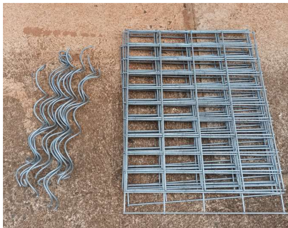
Figura 32. Painéis e conexões em espiral do Gabião Eletrossoldado. Fonte: Dados da Pesquisa
