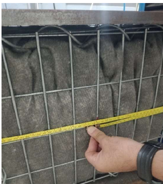
Figura 36. Aferição da deformação horizontal no eixo do gabião com trena. Fonte: Dados da Pesquisa
