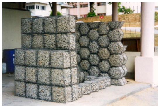
Figura 42. Paredes de gabião confeccionados para os ensaios Fonte: Mahyuddin(2013)
