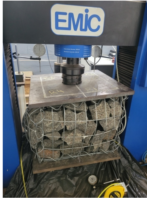
Figura 75. Corpo de prova de gabião submetido a ensaio de compressão simples Fonte: De autoria própria
