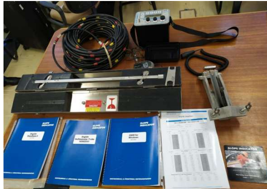
Figura 40. Inclínômetro usado na instrumentação Fonte: Andrade Neto e Freire (2019)
