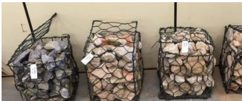
Figura 45. Corpos de prova de gabião com RCC Fonte: Camelo (2019)
