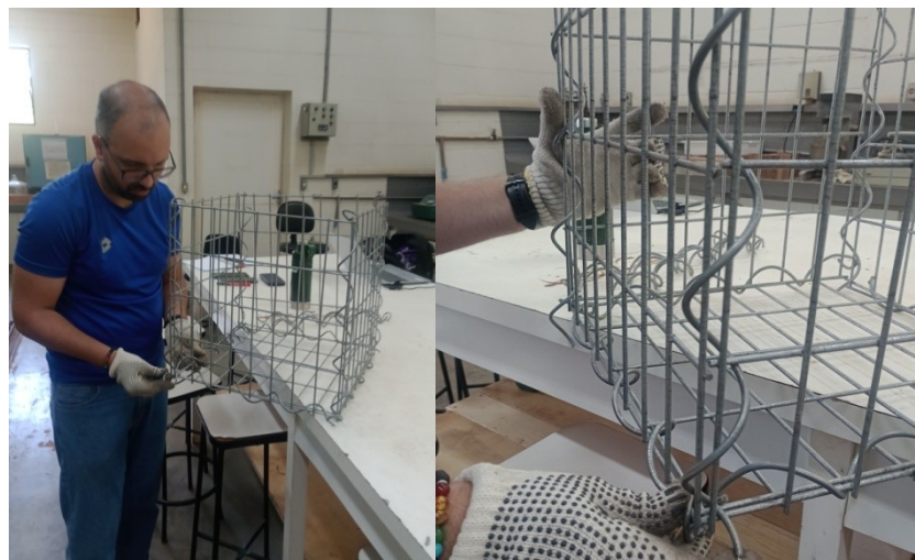
Figura 71. Montagem dos gabiões eletrosoldados para realização do ensaio Fonte: De autoria própria
