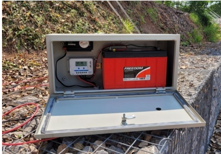
Figura 66. Caixa com instrumentação para envio dos dados dos sensores Fonte: De autoria própria
