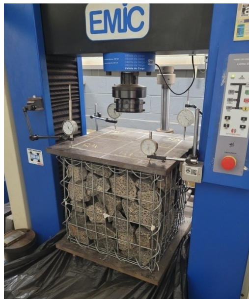
Figura 72. Equipamento usado para o ensaio de compressão dos gabiões Fonte: De autoria própria
