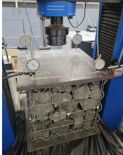
Figura 74. Corpo de prova montado e instrumentado para início do ensaio Fonte: De autoria própria
