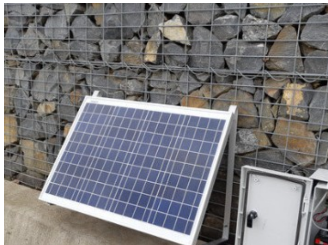
Figura 50. Imagem do gateway IQRF ® /GSM e do painel solar instalados no muro de gabião Fonte: Pieš (2020)
