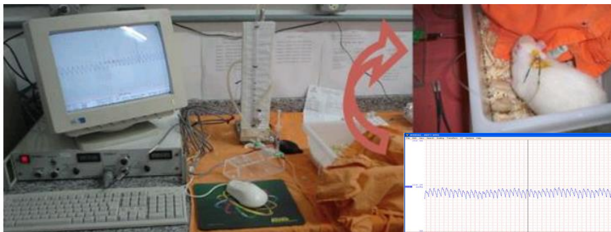
Figura 11. Sistema de registro de pressão arterial. Imagem mostrando conexão entre a cânulaxteriorizada no dorso do rato WISTAR e o transdutor de pressão arterial; bem como registro da VFC (canto inferior direito). Extraído e adaptado de SANCHES, 2012.
