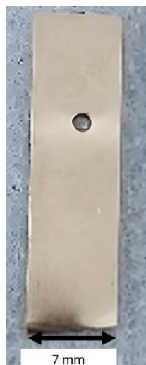
Figura 8 Tira de aço perfurada com a fresa 1.2mm SIN® utilizada para marcação do diâmetro da perfuração com o laser de Er:YAG.
