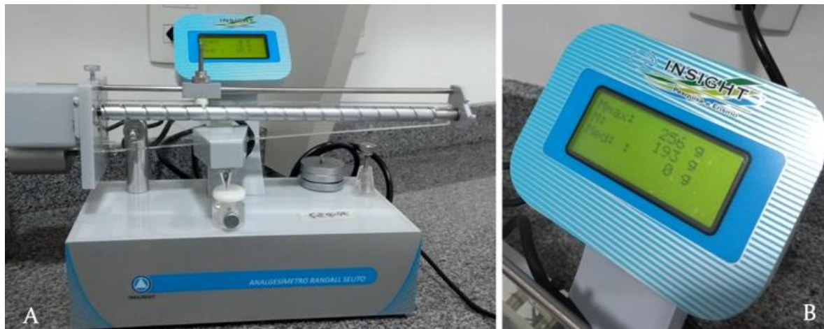
Figura 6. Em A: Algômetro Randall Selito (Universidade Nove de Julho); Em B: Medidor em gramas do aparelho, definindo a carga limite da alodinia mecânica (Arquivo pessoal).
