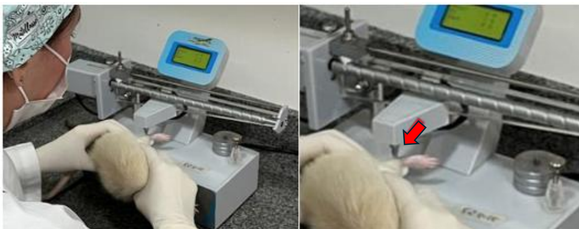
Figura 09: Teste de Alodinia Mecânica: Articulação do tornozelo traseiro posicionada no Algômetro. (arquivo pessoal).
