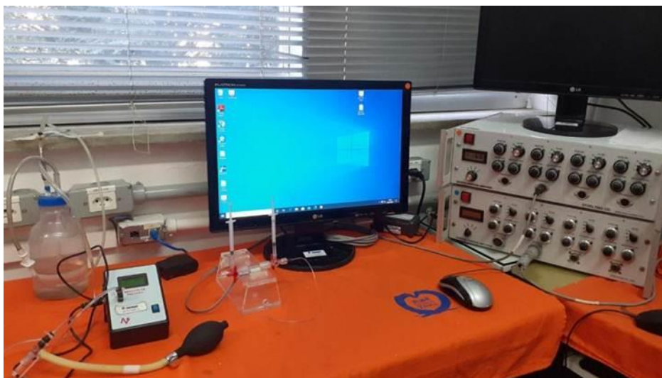
Figura 3 – Sistema de Registro da Pressão Arterial. Fonte: Laboratório de Fisiologia do Exercício – Universidade Federal de São Paulo
