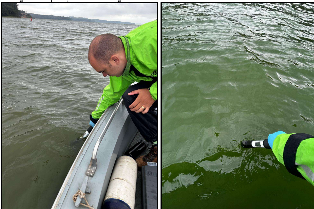
Imagem 1 - Aplicação da Sonda AlgaeTorch no monitoramento.
