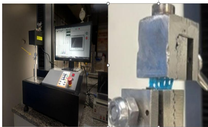
Figura 17: Teste de resistência mecânica no equipamento Intermetric - linha iM
