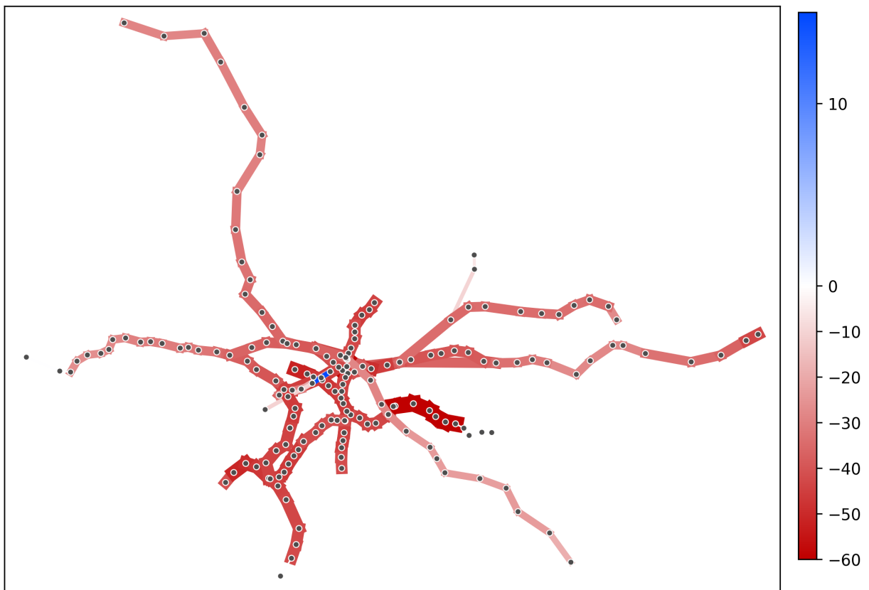
Figura 4.7 – Variação percentual na intensidade dos fluxos de passageiros ao longo de cada segmento ferroviário e metroviário entre março de 2019 e março de 2020. Cada segmento de linha representa uma conexão entre duas estações na rede de São Paulo. A escala de cores varia do vermelho, indicando fortes reduções no número de viagens, ao azul, indicando fortes aumentos, sendo o branco associado a variações desprezíveis. A espessura de cada segmento é proporcional à magnitude absoluta da variação no fluxo, de modo que segmentos mais espessos correspondem a mudanças mais intensas, independentemente de serem aumentos ou reduções.
