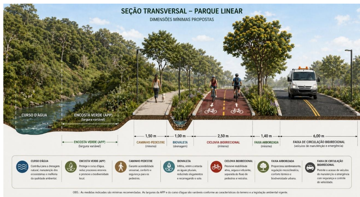
Figura 17 – Seção transversal proposta para parque linear com intervenção unilateral.
