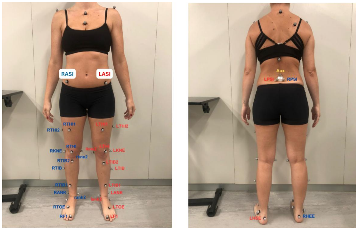
Figura 1: Conjunto de marcadores retro-reflexivos posicionados nas estruturas e segmentos anatômicos para a aquisição de dados cinemáticos.
